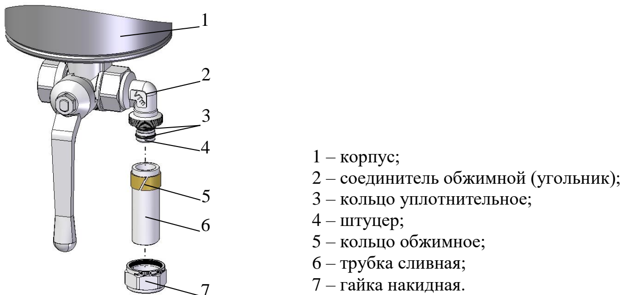
Рисунок 2.6 – Подсоединение сливной трубки к ТО с арматурой
