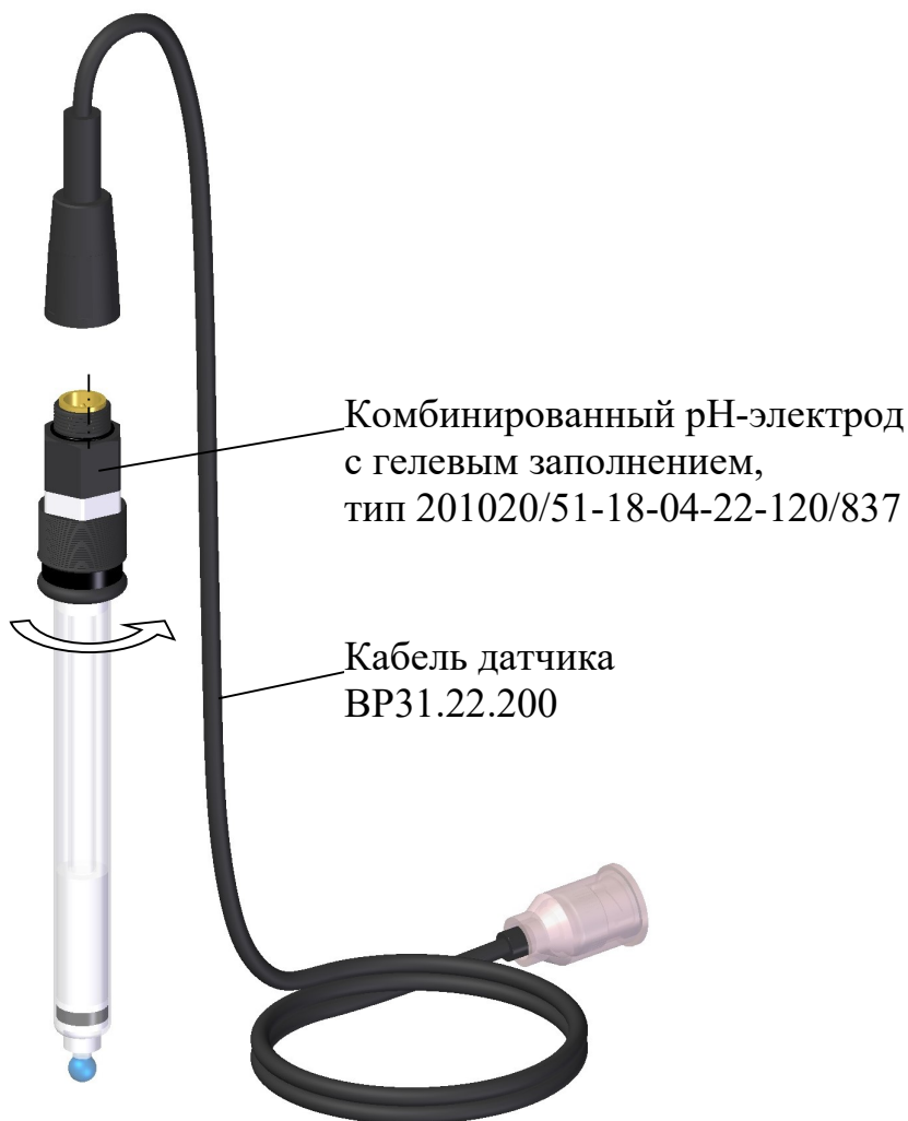
Рисунок 2.3 – Подсоединение кабеля датчика к электроду
