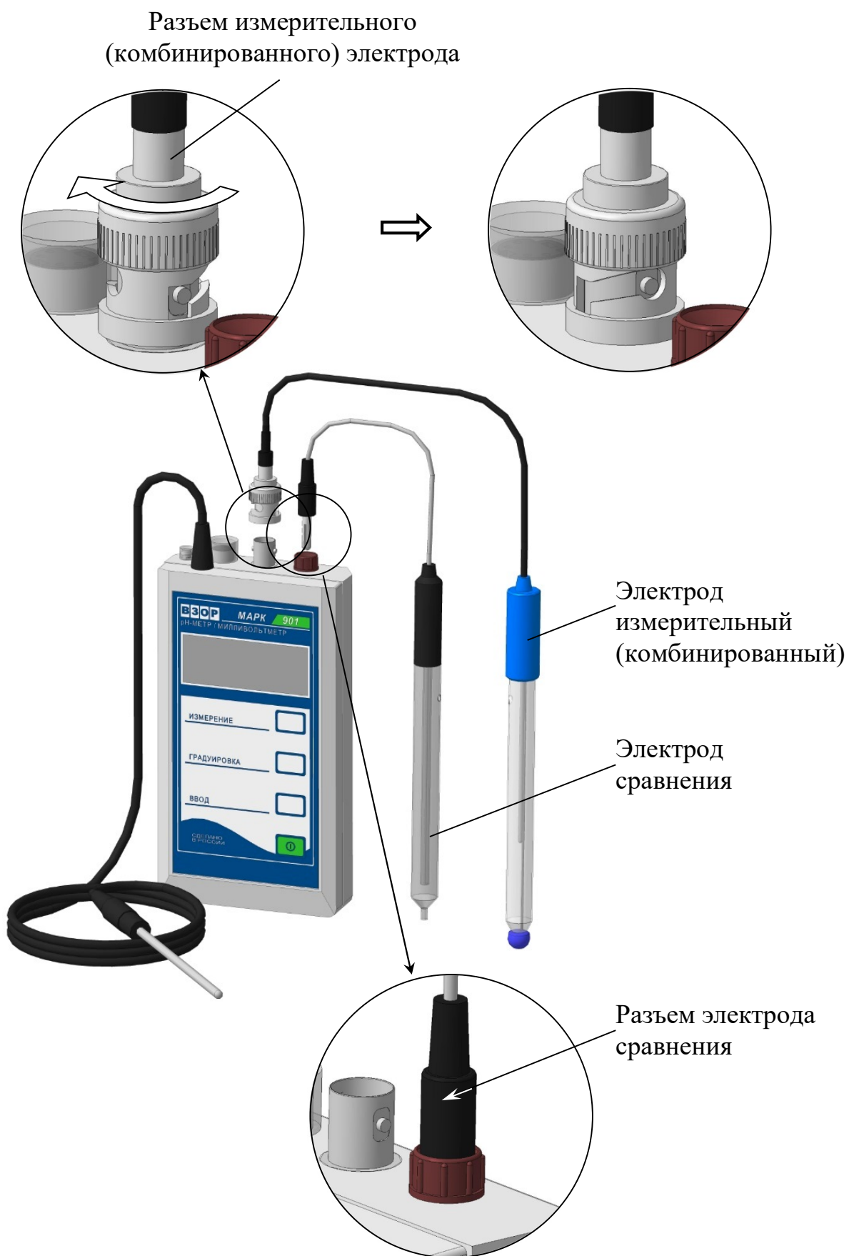
Рисунок 2.4 – Установка электродов
