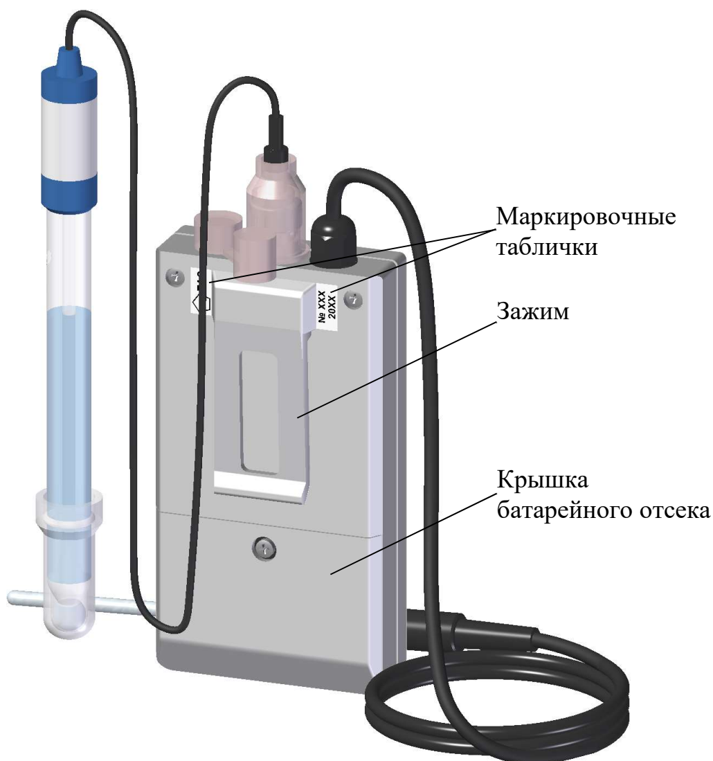
Рисунок 1.2 – pH-метр МАРК-903 (вид сзади)
